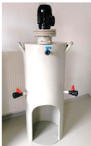
Figur 1: 80 liter testanlæg med kraftig omrøring og varmekappe
